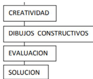
Los dibujos constructivos pueden llegar a presentarse en diferentes ocasiones de la metodología, se generan dibujos constructivos preliminares antes de la construcción de prototipos, se ajustan los dibujos constructivos después de la evaluación de los prototipos, e incluso se modifican los dibujos constructivos después de la fase de evaluación, no siendo hasta después de las aportaciones de la evaluación que se desarrolla la última versión de los dibujos constructivos finales. (Herrera, R. 2018)
