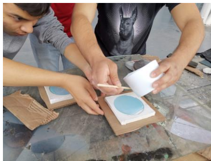
Figura 16. Proceso para elaborar molde de hule y vaciado de resina cristal
